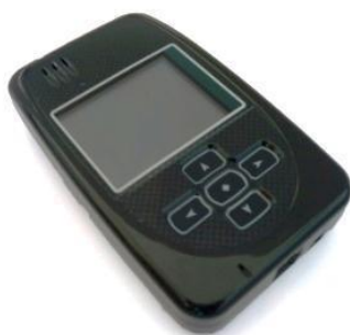
Obrázok č. 3: Zariadenie na určenie aktuálnej geografickej polohy kontrolovanej osoby
