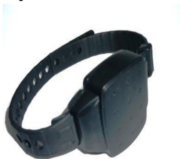
Obrázok č. 1: Elektronický náramok na kontrolu prítomnosti
